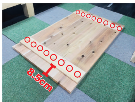
4 ひのきの板材を端から約8.5cmのところ細ビス(25mm)で止めます。
