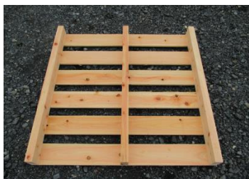
8 各部分釘を2～3本ずつ止めたら裏返して下さい。
