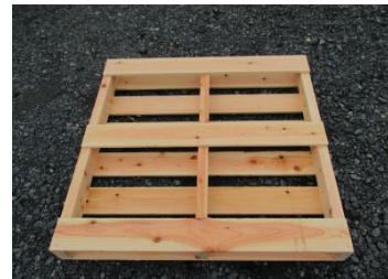
9 手前と奥の板の両端を釘で止めて下さい。
