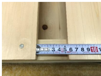
6 5.6cm間隔で上板を止めていきます。 (オプションで上板を追加した場合は、約2.5cm間隔になります。)
