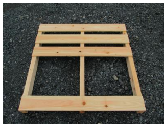
7 間に上板4枚を入れ、5.6cm間隔で釘で止めて下さい。 (オプションで上板を追加した場合は、間に上板5枚を入れ、約2.5cm間隔で止めて下さい。)
